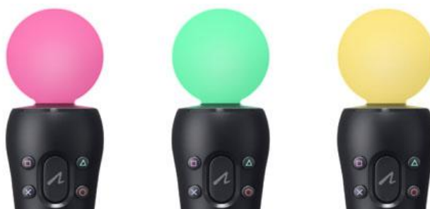
Figura 3.11. Esfera iluminada del dispositivo PS Move
